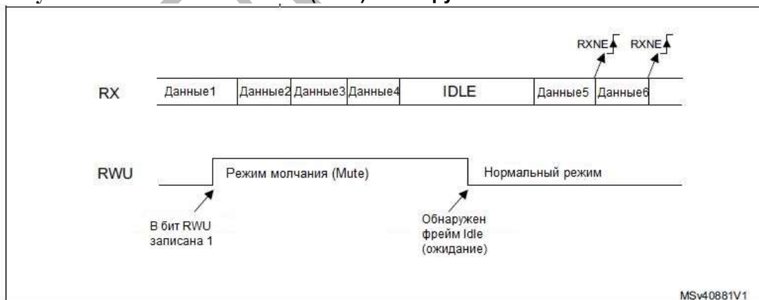
Рисунок 116. Режим молчания (Mute) с обнаружением линии Idle
