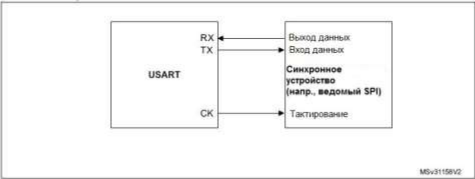
Рисунок 119. Диаграмма тактирования данных USART (M=0)
