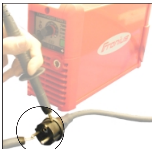
Abb. 24 Isolationstest - Primärstromkreis / Masse
